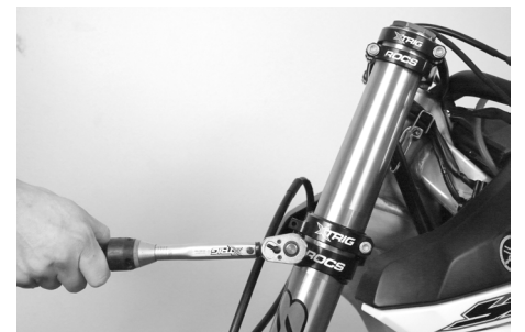
Gabelklemmung der unteren Gabelbrücke mit 17Nm festziehen..
