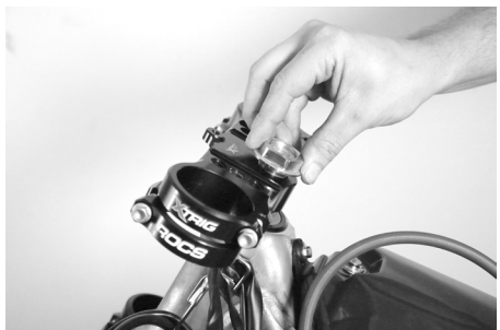
Obere Gabelbrücke aufsetzen und die Serien Einstellmutter mit Hand andrehen.
