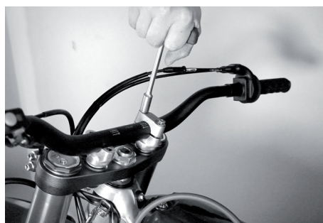
Lenker und eventuelle Befestigungen wie Kabelbinder demontieren
