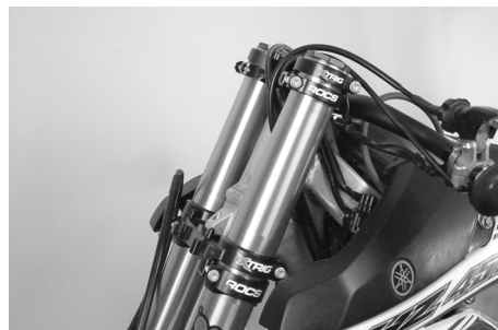
Gabel samt Vorderrad und Bremsanlage in die Gabelbrücke einsetzen. Auf Gabelüberstand achten.
