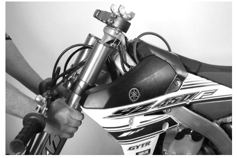
Gabel samt Vorderrad und Bremsanlage nach unten herausziehen.
