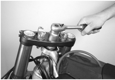
Befestigungsmutter der oberen Gabelbrücke lösen
