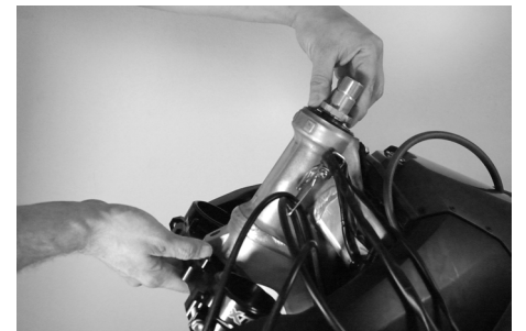
Nun die Serien Einstellmutter des Lenkkopflager montieren. Anzugsdrehmoment aus dem Hersteller Fahrer-Handbuch entnehmen (Auf Dichtscheibe oder O-Ring achten)
