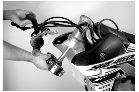
Untere Gabelbrücke demontieren, den Lenkkopf und den Lagersitz des Motorrades reinigen.
